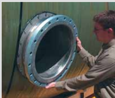
Уплотнительная манжета на входах в резервуары различных диаметров (включая болты и т.п.)
